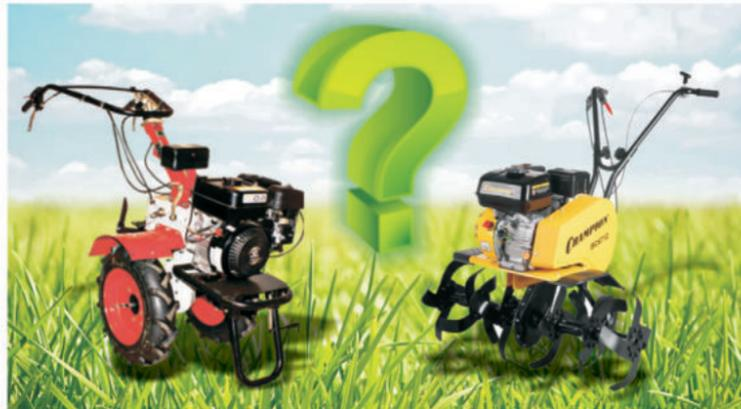
слоя почвы. Работа мотокультиватора обеспечивается вращением фрез на ведущей оси. Укомплектовывается мотокультиватор чаще всего только фрезами и небольшими транспортировочными колесиками.
